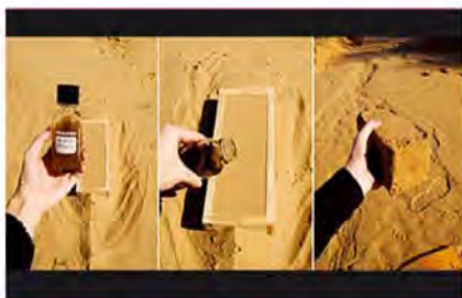
Sandbrick: (Bacteria Bacillus pasteurii que cementa estructuras granulares) Ginger Dosier (2007).
