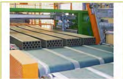
Pasta cerámica tras pasar por el molde y en la zona de corte en Bovedillas Cerámicas Andaluzas (BCA) http://www.bovedillas.com/
