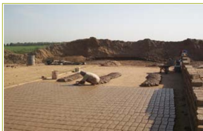
Trabajador introduciendo la mezcla cerámica en las gaveras y ladrillos recién moldeados, en Aljarasur Elaboración propia
